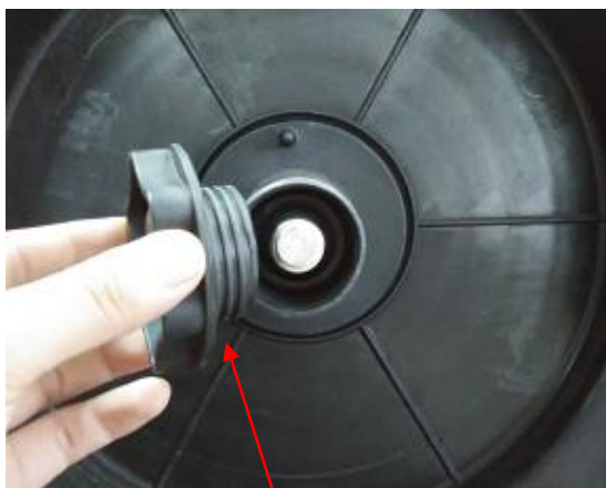
(1) Îndepărtați piulița de fixare a bobinei.
