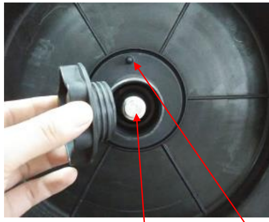
(2) Observați dispozitivul de reglare a arcului de tensiune și știftul de fixare a bobinei.
