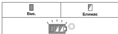
Якщо інструмент не запускається, це може означати, що акумулятор перегрівся. У такому випадку дозвольте акумулятору охолонути, перед чим знову ввімкніть інструмент.
