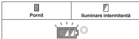
Dacă mașina nu pornește, acumulatorul poate fi supraîncălzit. În această situație, lăsați acumulatorul să se răcească înainte de a porni din nou mașina.
